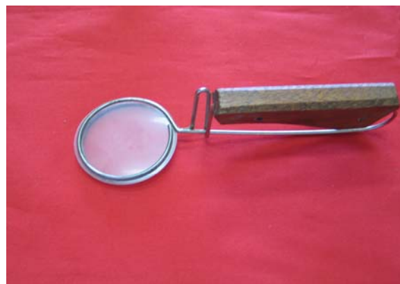
شکل ۱- Plastic shield با گیره مخصوص جهت فرم دادن الگوی فریم
