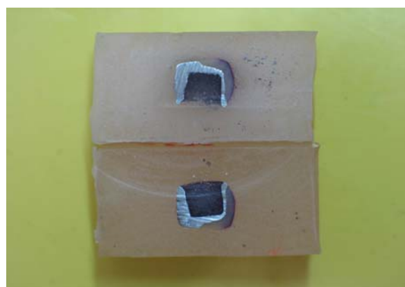
شکل ۶- برش نمونه‌های مدفون شده در آکريل شفاف
