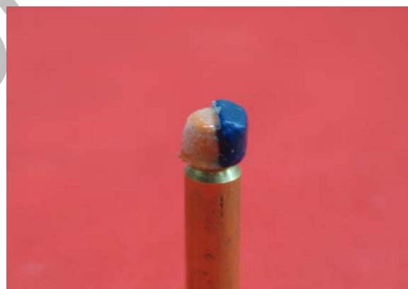
شکل ۲- الگوی کامل شده آماده کستینگ
