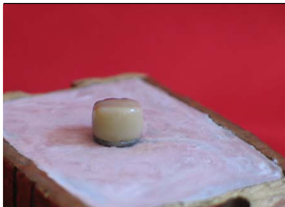
شکل ۵- ماده ونیر یک شده بر روی فریم فلزی با ضخامت ۱/۵ میلی‌متر
