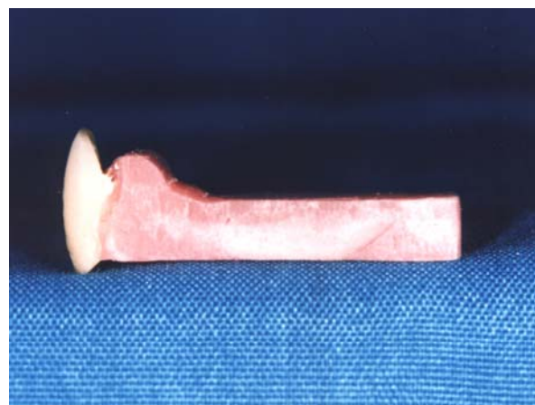
شکل ۲- نمونه نهایی که شامل یک دندان مصنوعی و پایه آکريلي متصل به آن است.
