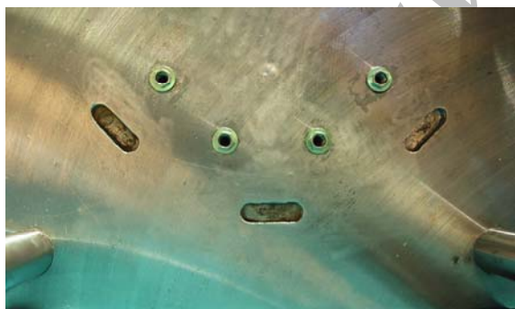
شکل ۲- ایمپلنت‌ها و شیارهای راهنما
