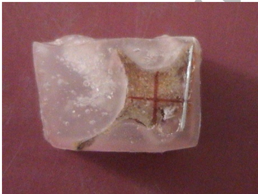
شکل ۲- نمونه‌ای از برش به دست آمده از دستگاه Acutum و اندازه‌گیری مستقیم ارتفاع و پهنای ریج روی آن
