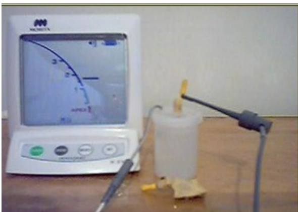
شکل ۳- نحوه قرار دادن دندان در قوطی و ارتباط Root ZX با آن
