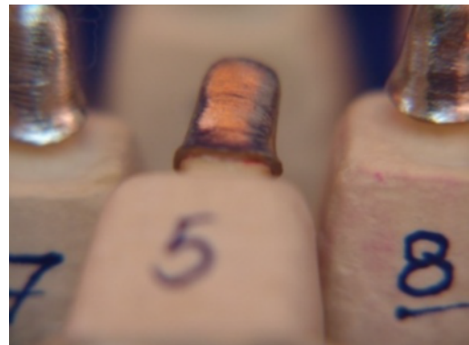
شکل ۳- کوپینگ ریخته شده با آلیاژ بگو استار
