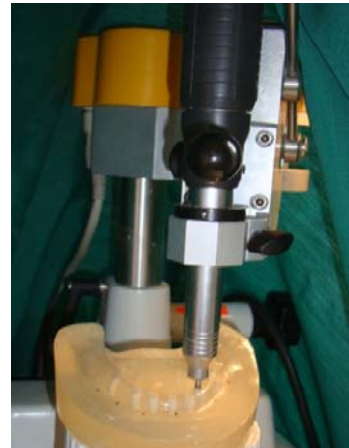
شکل ۲ - انجام دریل به صورت موازی توسط میلینگ ماشین (paraskop M (Germany, Bremen, Bego
