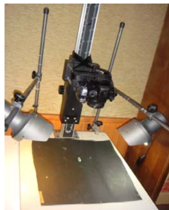
شکل ۱- دستگاه مورد استفاده در مطالعه ( نحوه تابش منبع نور و نحوه قرارگیری نمونه)
