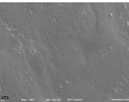
شکل ۹- سطح بدون آماده‌سازی سطحی با بزرگنمایی ۲۰۰ برابر
