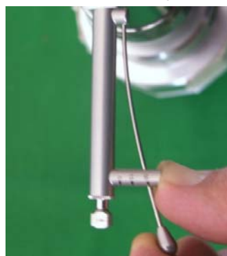
شکل ۲- رسیدن به تورک نهایی با انحناء برداشتن کمان (Flexing of bow) و رسیدن به تورک هدف از پیش تعیین شده مشخص می‌شود.
