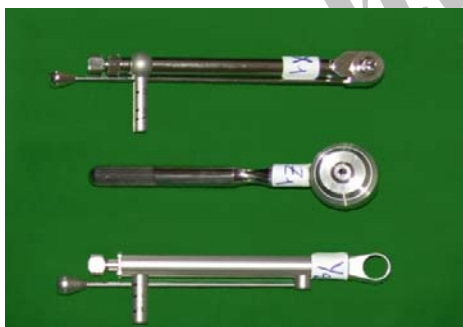
شکل ۱- محدود کننده‌های مکانیکی تورک از نوع فنری بالا Nobel Biocare، وسط 3i و پائین ITI
