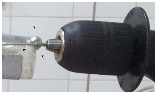
شکل ۲- طرح آزمایشگاهی: (۱) هندپیس متصل به بازوی ثابت (۲) ایمپلنت متصل به بازوی قابل تنظیم (۳) الکترو ترموکوپل متصل به ایمپلنت.
