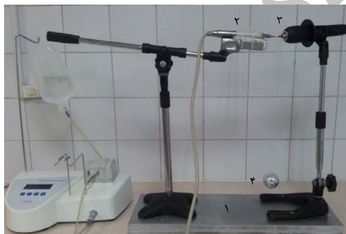
شکل ۱- طرح آزمایشگاهی: (۱) صفحه چوبی (۲) هندپیس پیژوالکتریک ثابت شده بر روی بازو (۳) بازوی قابل تنظیم نگهدارنده ایمپلنت و (۴) وزنه ۱۰۰ گرمی.
