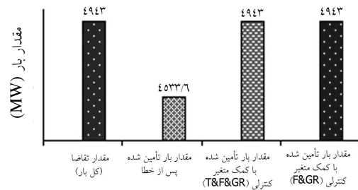
شکل ۱۷ مقادیر بار بازیابی شده در حالت‌های استفاده از ترکیب متغیرهای کنترلی (F&GR) و (T&F&GR) در مقایسه با بار تأمین شده پس از خطا و کل بار در شرایط خروج نیروگاه ۷۰۷ مگاواتی شینه ۸۹
