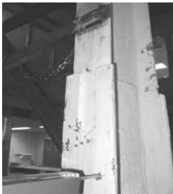
شکل ۲۴ اتصال قطعه نمونه به تیر میانی پس از آزمایش
