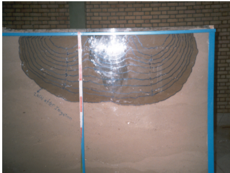
شکل شماره ۳- شمایی از خطوط پیشروی جبهه رطوبتی در زمان‌های مختلف از سه خروجی مجاور هم در حین آزمایش
