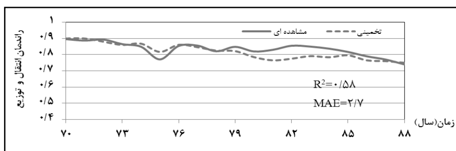
شکل ۱۴- داده‌های مشاهده‌ای و تخمینی راندمان انتقال و توزیع در شبکه آبیاری قزوین.
