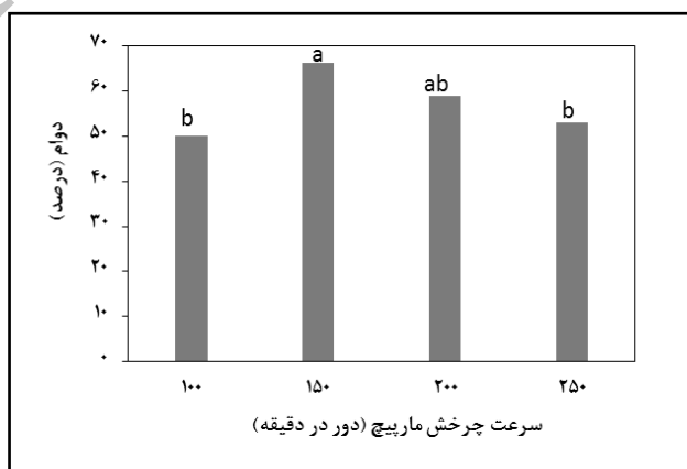
شکل ۷- اثر سرعت چرخش ماریپیچ اکسترودر بر دوام پلت‌های تولید شده با مقدار رطوبت متفاوت.
