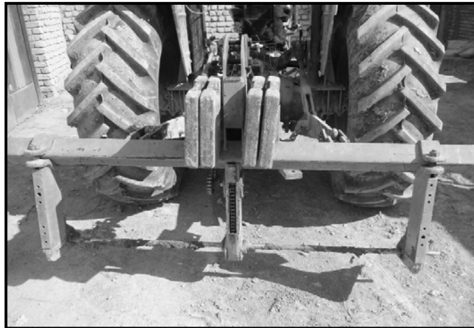
شکل ۵- پیازکن میله‌ای در حالت عقب‌سوار با وزنه‌های سنگین‌کننده
