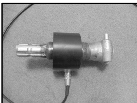
شکل ۳- تورک متر مدل Datum Electronics Torque Log
