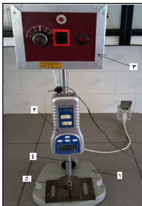
شکل ۱- دستگاه سختی سنج مورد استفاده در آزمایش برای اندازه گیری نیروی گسیختگی دانه (۱- سکوی بارگذاری، ۲- نیروسنج دیجیتال، ۳- موتور محرک و واحد انتقال توان، ۴- پروب بارگذاری و ۵- محل استقرار دانه)
