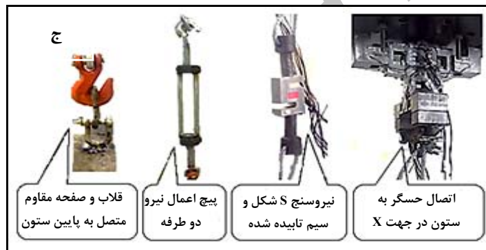
شکل ۶- نمای کامل از سیستم واسنجی حسگر: (الف) اعمال نیرو در جهت X، (ب) اعمال گشتاور حول محور Y و (ج) نمایش بخش‌های مختلف سیستم واسنجی حسگر
