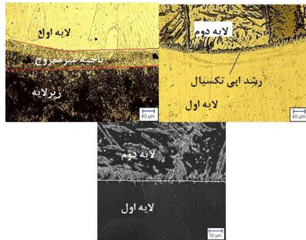
شکل ۱۴. تصاویر میکروسکوپی نوری و الکترونی از فصل مشترک‌های فلز جوش ER ۳۱۲
