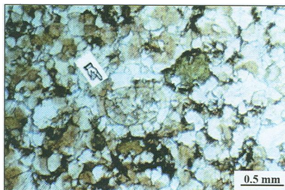
شکل ۳: رخساره گریستون ائویدی قلوهدار که در آن قلوه های شیلی سبز رنگ (Sh) دیده می شوند. پدیده نوریخت زایی سبب شده است فقط سایه ای از ائویدها (انگشت اشاره) باقی بماند، نور طبیعی.
