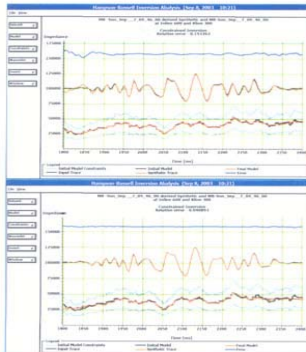
شکل 3- اثر تعداد تکرار بر نتیجه حاصل از وارون سازی در محل چاه شماره 1 آب تیمور. شکل بالا به ازای تکرار 2 و شکل پایین به ازای تکرار 300 است. سایر پارامترها عبارتند از: 35 درصد برای مرز سخت و 4 میلی ثانیه برای اندازه بلوک است.
