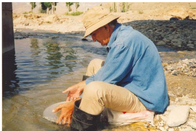
شکل ۵- تغلیظ نمونه‌های کانی سنگین به روش لاوک کوچک.
