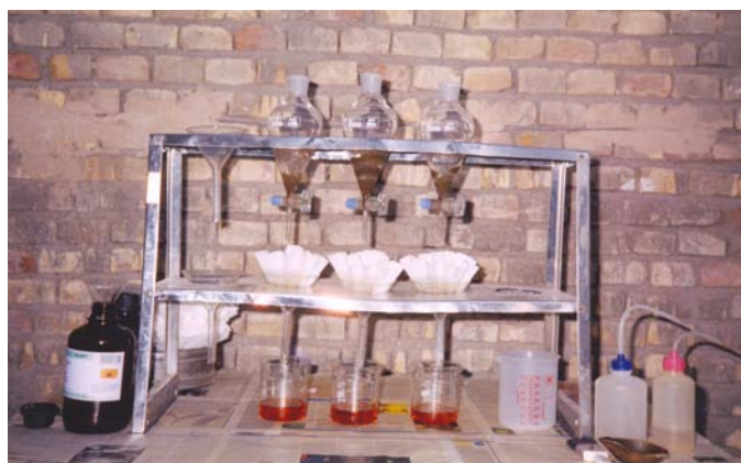
شکل ۶- جدایش بخشهای سبک و سنگین نمونه‌های کانی سنگین با استفاده
