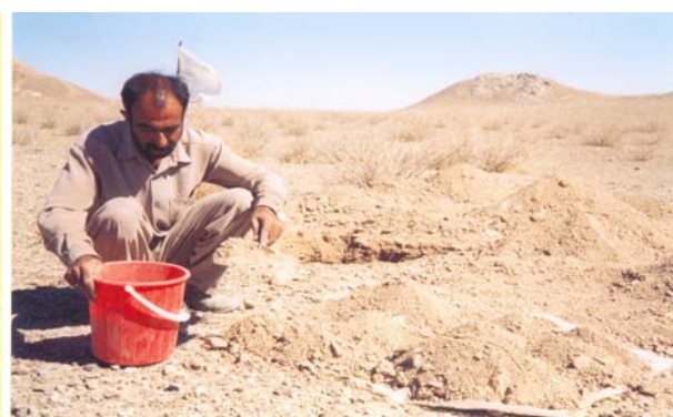
شکل ۳- شیوه حفر چاهک دستی و برداشت نمونه معرف به روش مخروط سازی و ریع کردن.
