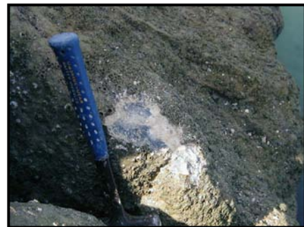
شکل ۲- سیاه شدن رویه سنگ آهکی مارنی، ناشی از انحلال شیمیایی در ناحیه کشندی
