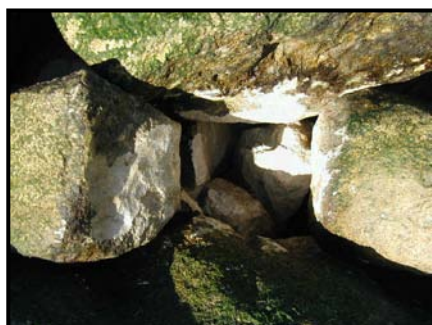
شکل ۱۴- فرسایش سنگ ناشی از وجود لایه‌های گچی حاوی انیدریت
