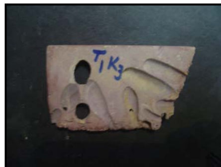
شکل ۴- نفوذ موجودات دریایی به درون سنگ آهک مارنی در ناحیه غرقابی
