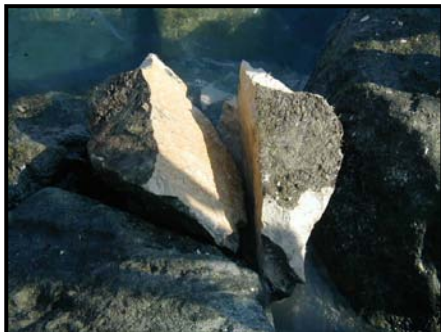
شکل ۳- کاهش مقاومت سنگ آهکی مارنی در ناحیه غرقابی
