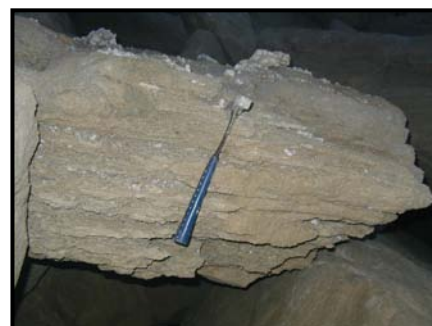
شکل ۱۴- فرسایش سنگ ناشی از وجود لایه‌های گچی حاوی انیدریت
