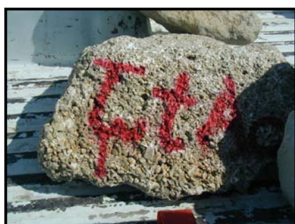
شکل ۱۳- سنگ کنگلومرای آهکی درشت دانه در ناحیه فراکشندی
