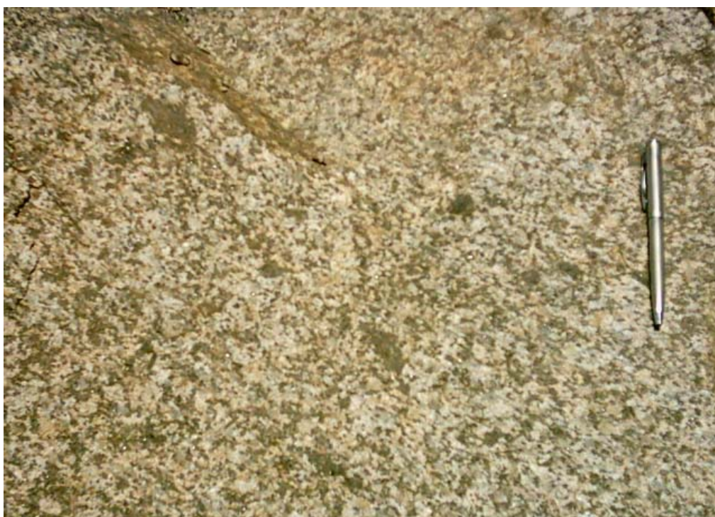
شکل ۶- هضم بیگانه سنگهای میکاشیستی درون گرانیت بن دو نو. بیگانه بلورهای بیوتیت حاصل از میکاشیستها از بیوتیت‌های ماگمایی توسط دو ویژگی از هم متمایز می‌شوند: (۱) بیگانه بلورها به صورت تجمع دیده می‌شوند. (۲) بیگانه بلورها ریز بلورتر هستند.
