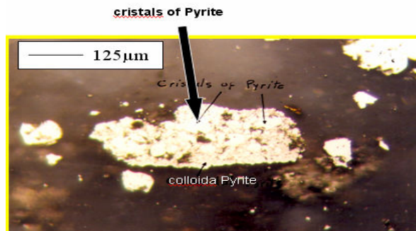
شکل ۸- تشکیل پیریت ژله‌ای (کلوئیدی) در اطراف بلورهای پیریت در نمونه T8-A با بزرگنمایی X250
