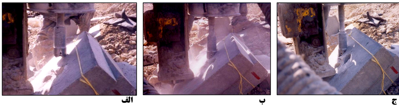
شکل ۶- مراحل مختلف نفوذ سر مته در سطح درزه‌های شیب‌دار مدل‌سازی شده الف) لحظات اولیه ورود مته به سطح بلوکهای مدل‌سازی شده (ب) مته در حال حفر سنگ ج) اتمام حفاری و ثبت زمان مربوطه در مطالعات زمان‌سنجی (ورود ۵ میلی‌متر از مته در مدل)
