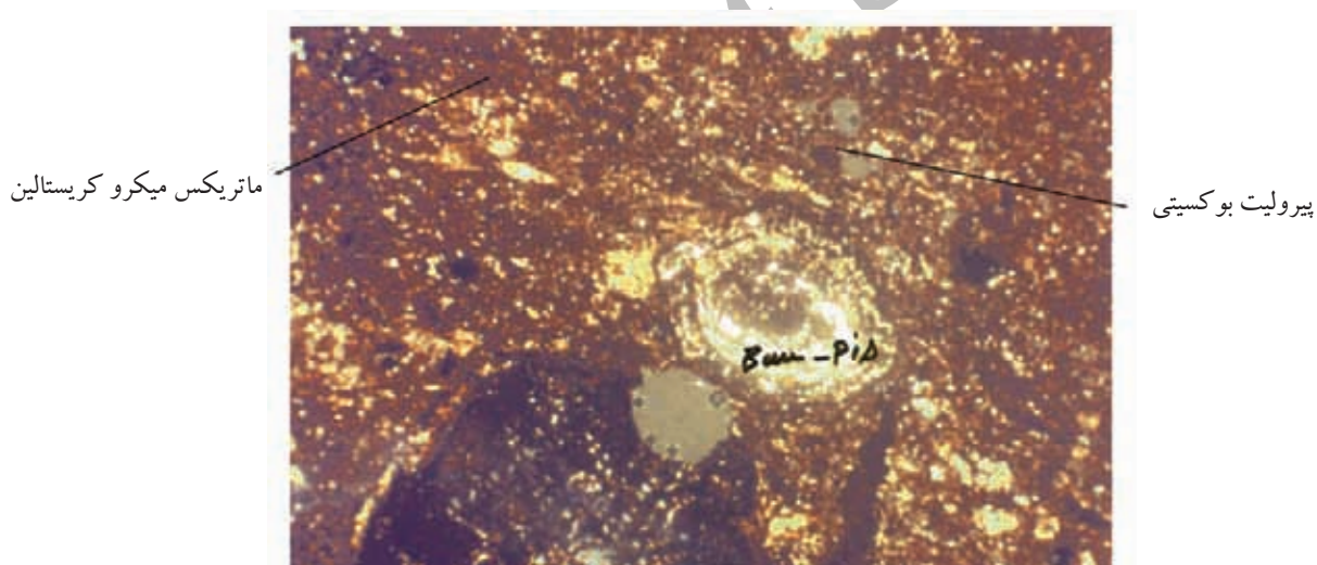
شکل ۱- مقطع نازک نمونه سنگی (۳۳ برابر نور پلاریزه)
