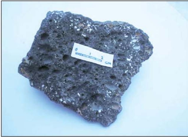
عکس ۳ - ساخت حفره‌ای در بازالت‌ها. حفره‌های حاشیه سنگ توسط کانی زئولیت « سفید رنگ » پر شده‌اند.
