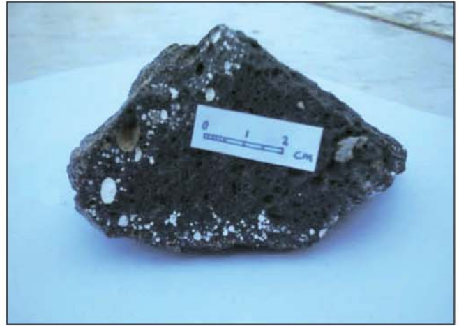
عکس ۳ - ساخت حفره‌ای در بازالت‌ها. حفره‌های حاشیه سنگ توسط کانی زئولیت « سفید رنگ » پر شده‌اند.
