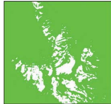
شکل ۴- نتیجه حاصل از طبقه‌بندی تصویر لندست ۷ با استفاده از طبقه‌بندی نظارت نشده، رنگ سبز منطقه غیر یخچال، رنگ سفید یخچال طبیعی (برف و یخ)
