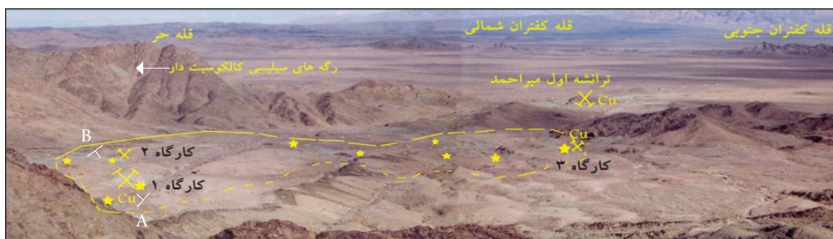
شکل ۴- نمایی از معدن مس چاه موسی (محدوده کانه‌زایی افشان- رگچه‌ای مس، محدوده خط‌چین) و موقعیت رگه‌های سیلیسی کالکوسیت دار ترانشه اول میراحمد و قله حر در سنگ میزبان توده نیمه‌آتشفشانی بیوتیت هورنبلند آندزیت پورفیری، دید به سوی شمال‌خاور، محل کارگاه‌های استخراجی ☆: محل‌های وجود رخنمون کانه‌زایی افشان- رگچه‌ای مس؛ A-B- محل مقطع زمین‌شناسی در شکل ۹ است. فاصله هوایی کارگاه ۲ تا کارگاه ۳ حدود ۳۵۰ متر است.
