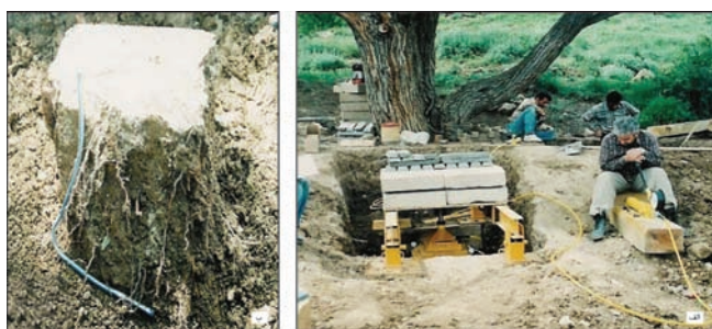
شکل ۳- الف) آزمایش در حال اجرا در ایستگاه میوانند، ب) اندازه گیری ریشه‌های بلوک خاک در پایان آزمایش
