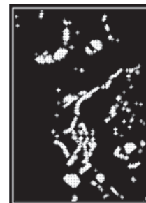
شکل ۹- محدوده استخراج شده یخچال با استفاده از فضای طیفی
