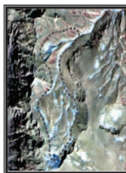
شکل ۱۳- تصویر تلفیق شده Aster و IRS یخچال خرسان و محدوده رقمی شده یخچال
