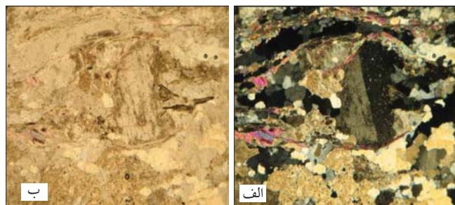
شکل ۱۶-الف) تبلور دوباره کوارتز و فابریک C/S با حرکت راست‌بر در گرانیت میلونیتی خاکو، بزرگنمایی 10X. ب) تصویر میکروسکوپی نور عادی.
