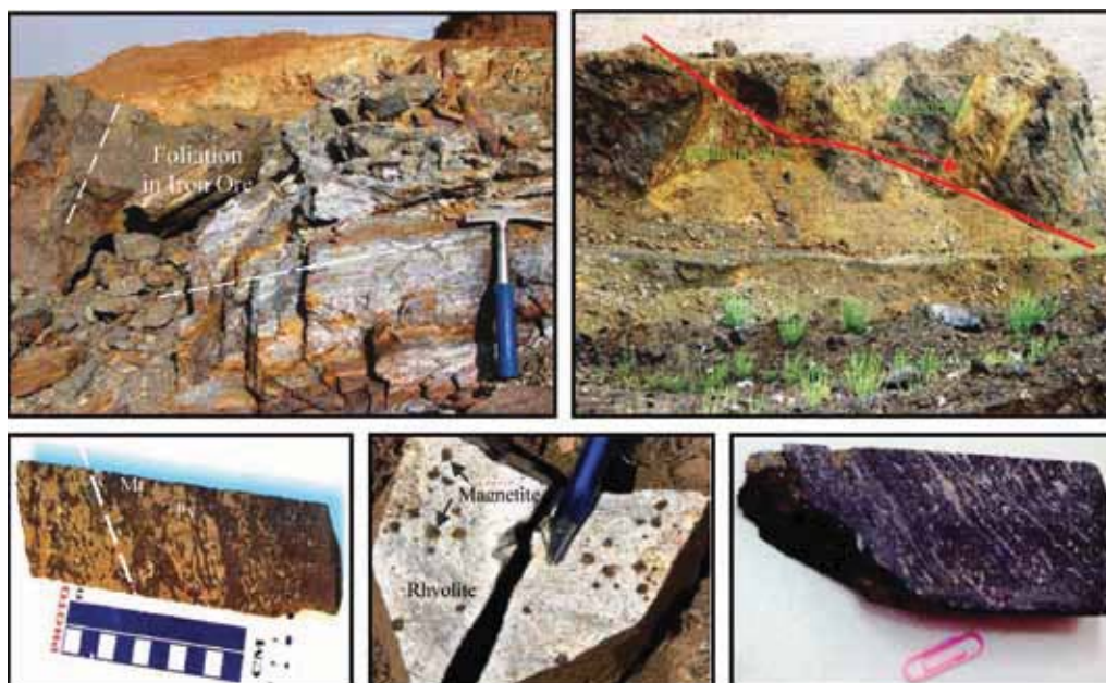
شکل ۲- اشکال مختلف کانی سازی آهن در کانسارهای باباعلی و گلالی: کانه چیره در این دو کانسار، مگنتیت است، ولی کانه‌های پیریت، پیروتیت، هماتیت، و کانی‌های مس از قبیل کالکوپیریت، مالاکیت و آزوریت نیز به همراه آن حضور دارند. بافت نواری پیریت و مگنتیت در راستای برگ‌وارگی (فولیاسیون) ترجیحی کانسنگ (خط چین) دیده می‌شود.
