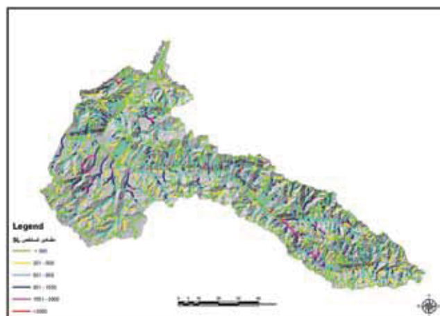
شکل ۴- پراکندگی میزان شاخص طول- شیب آبراهه‌ها (SL)، در شبکه زهکشی رودخانه‌های طالقان رود، شاهرود و سفیدرود
