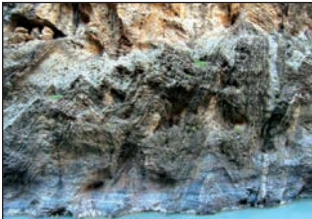
شکل ۲۴- توالی چین خوردگی های جناغی در طول مسیر رودخانه (ساختگاه سد بختیاری، زاگرس چین خورده)
