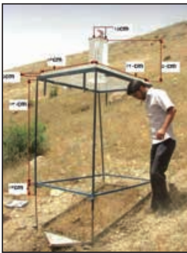
شکل ۷- شبیه ساز باران قابل حمل (۱۲۰×۸۴ سانتی متری) در واحد کاری ۱-۳-۳ حوضه هیو.
