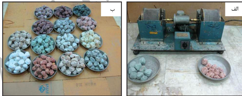
شکل ۴- الف) دستگاه آزمایش دوام (ب) نمونه‌های تهیه شده برای آزمایش
