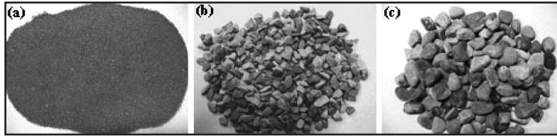
شکل ۳- مصالح مورد استفاده در آزمایش‌ها (a) خاک ماسه‌ای پایه، (b) شن تیز گوشه و (c) شن گرد گوشه.
