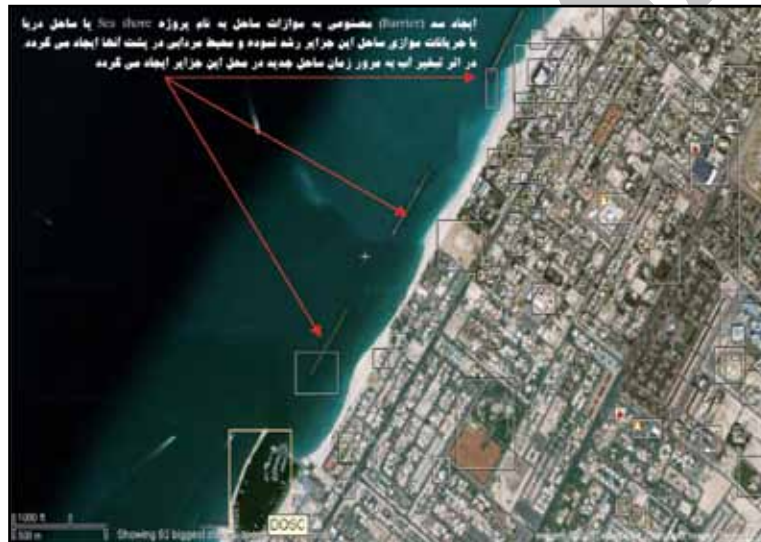
شکل ۳- ساخت سدهای ماسه‌ای کم عرض و به موازات ساحل که سبب توسعه و پیشروی ساحل دری به سمت خلیج فارس شده است (تصویر مربوط به سال ۲۰۰۸ است).
