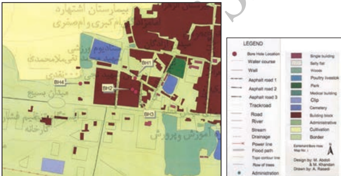
شکل ۶- نقشه موقعیت گمانه‌های ژئوتکنیکی در محدوده شهرک طالقانی اشتهارد.
