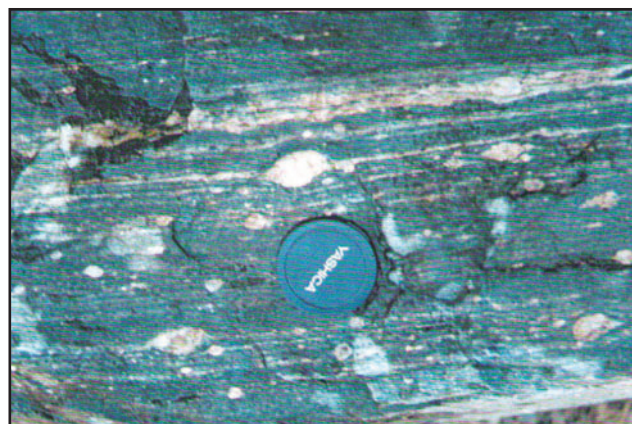
شکل ۱- نمایی از بافت میلوئیتی در سنگ‌های دگرریخت شده منطقه مورد مطالعه
