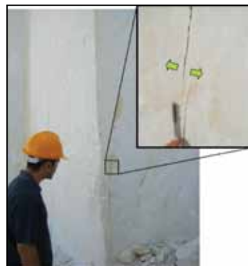
شکل ۶- نمایی از دسته درزه ۱ در روش نوین با بازشدگی و بدون پرشدگی در دیواره معدن. بررسی‌ها نشان می‌دهد این درزه‌ها جوان و در حال گسترش هستند.
