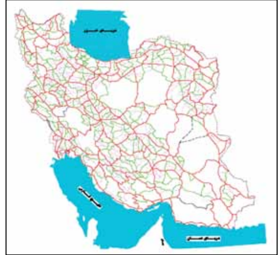
شکل ۱- شبکه‌های ملی ترازبایی دقیق ایران. شبکه درجه ۱ به رنگ سرخ و با طول بیش از ۳۰۰۰۰ کیلومتر، شبکه درجه ۲ به رنگ سبز و شبکه درجه ۳ به رنگ بنفش. طول شبکه‌های درجات ۲ و ۳ در مجموع بیش از ۵۰۰۰۰ کیلومتر است.
