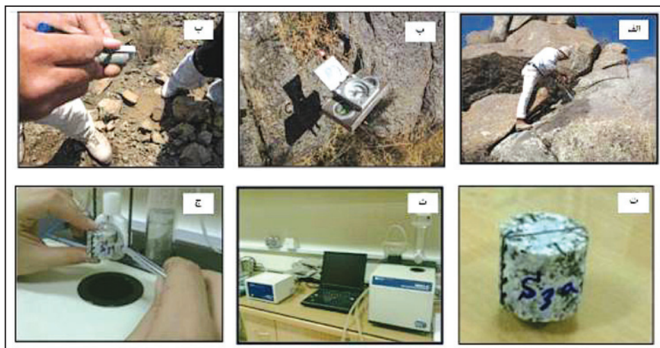
شکل ۳- مراحل نمونه‌گیری، آماده‌سازی و اندازه‌گیری برای مطالعه به روش AMS. الف) مغزه‌گیری با استفاده از ماشین مغزه‌گیر؛ ب) اندازه‌گیری میل و سوی میل مغزه؛ پ) علامت‌گذاری روی مغزه پس از بیرون آوردن از محل؛ ت) نمونه برش داده شده؛ ث) دستگاه MFK1-F برای اندازه‌گیری پذیرفتاری مغناطیسی؛ ج) قرار دادن نمونه در دستگاه.
