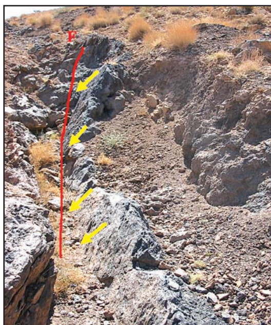
شکل ۹- گسل عادی جوان که باعث تمرکز ماده معدنی، در کانسار گلی شده است، پیکان‌ها جهت حرکت قطعه فرادیواره را نشان می‌دهند.
