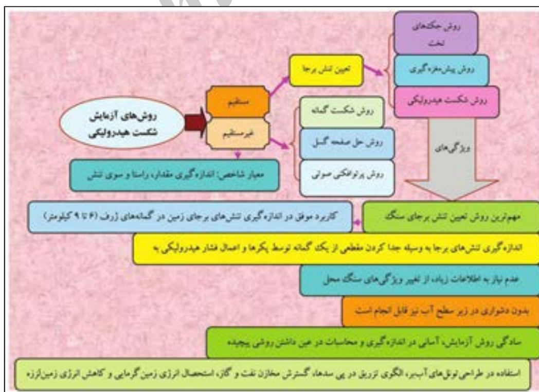
شکل ۳- روش‌های آزمایش شکست هیدرولیکی.
