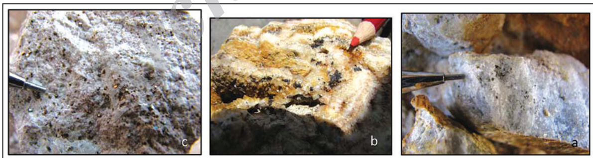
شکل ۸- (a) کانی‌سازی پراکنده پیریت سالم؛ (b) پیریت اکسید شده درون رگه‌های سیلیسی؛ (c) پیریت اکسید شده در متن سنگ‌های دگرسان شده.
